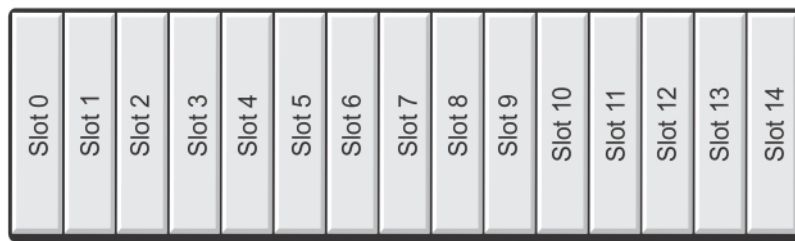
Abbildung 8. Laufwerksteckplätze im Dell PowerVault MD1000-Speichergehäuse
